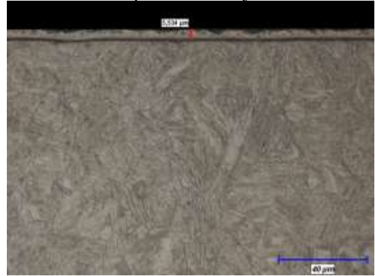
Şekil 3. 1000 °C'de 6 Saat Süre ile Gerçekleştirilen VC Kaplama Morfolojisi
