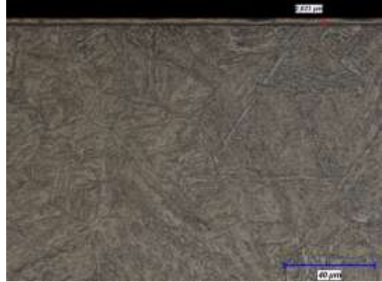
Şekil 1. 1000 °C'de 2 Saat Süre ile Gerçekleştirilen VC Kaplama Morfolojisi
